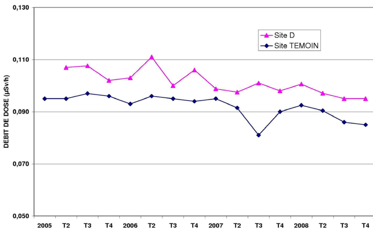
Figure 7 : Evolution du débit de dose moyen ( \mu\text{Sv/h} ) mesuré trimestriellement sur le site D et sur le site témoin entre 2005 et 2008.
