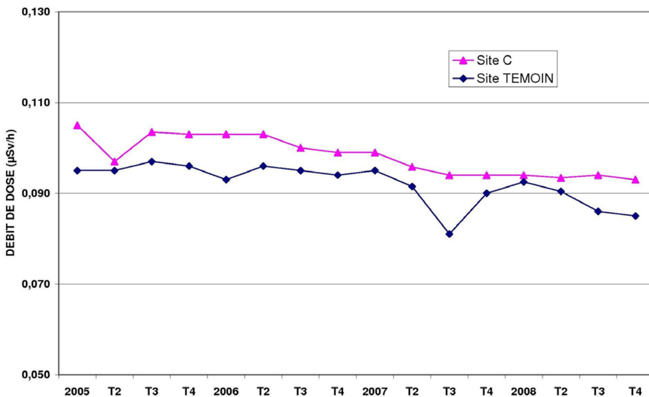
Figure 6 : Evolution du débit de dose moyen ( \mu\text{Sv/h} ) mesuré trimestriellement sur le site C et sur le site témoin entre 2005 et 2008.
